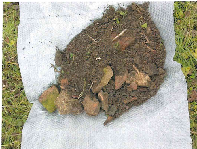
Figura 18. Campionamento per quartatura del materiale in cumulo presente in loc.tà Pioppa – Porto Viro (RO).
